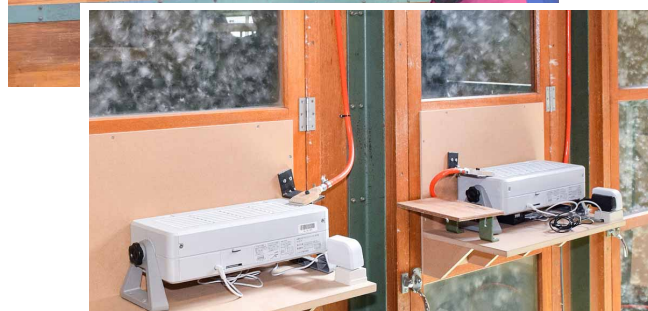
選別機の中の羽毛に、プラズマクラスターの風が当たるよう設置
