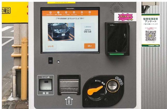
カメラで撮影された車両の映像が映し出されるので分かりやすい
