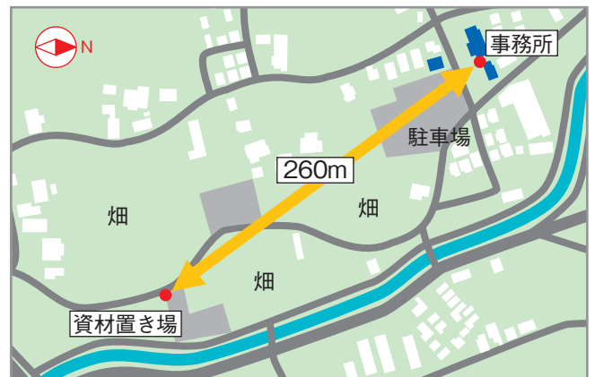
260m離れた監視カメラ映像を無線LANアクセスポイントで伝送
