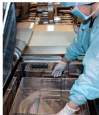
(左) 洗浄物は専用バスケットに入れて、まとめて投入可能 (右) 低侵襲手術用の鉗子などに使用できる専用アダプタも活用
