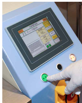
(左) あらかじめプログラムした洗浄コースを選択し、運転をスタート (右上) フットスイッチで上蓋が自動開閉 (右下) 洗浄剤も自動投入
