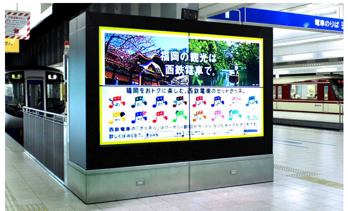
1番線の車止め前に設置された4面マルチディスプレイ。 超指向性スピーカーにより、一定のエリアだけ音声聞こえる工夫をされ、構内放映がしやすくなっている
