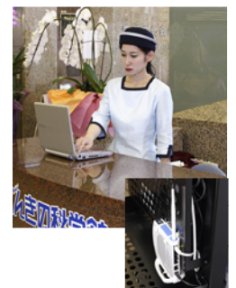
ウェルカムボードの表示は受付カウンターで遠隔操作。『PN-655』の背面には、無線LANのアクセスポイントが設置されている。
