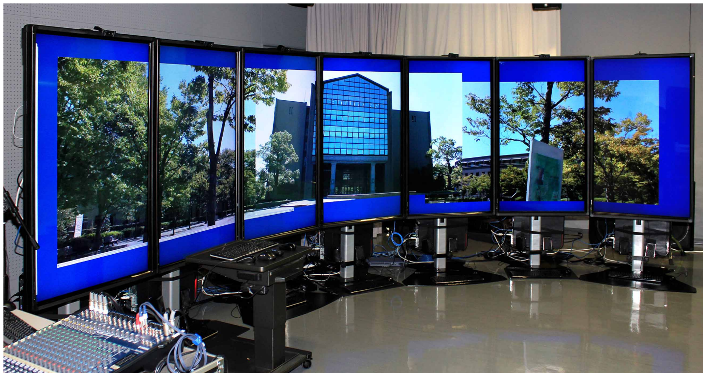
弧を描いた形状で7面マルチディスプレイを構成 (写真は全て研究途中のものです)
