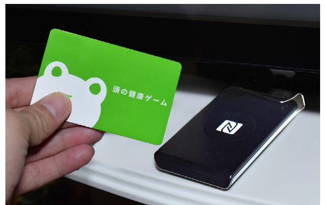
カードリーダーにカードをかざすことで、簡単に個人認証できる
