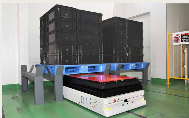
パレットの下に潜り込んでリフトアップ (許容荷重582kg)
