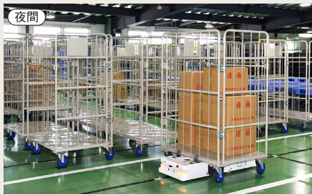
翌日使用する部材を2F倉庫から1F生産ラインへ夜間に無人搬送
