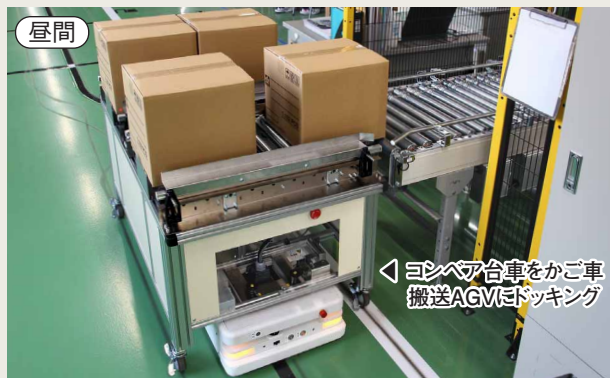
コンベア連結で完成品を受け取り、出荷のコンベアへ自動搬送
