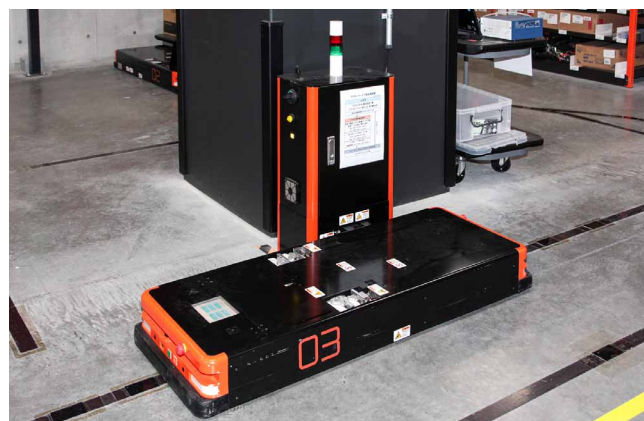
非接触給電ユニットの所定位置に自動で止まって充電
