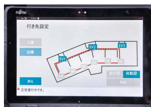
タブレット端末でAGVの呼び出し、行き先の設定が簡単にできる
