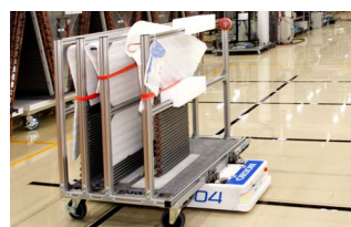
部品の配送、組立途中および完成した製品の次工程への搬送を自動化
