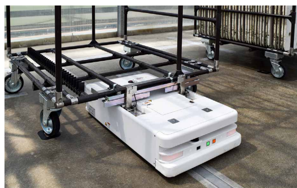
カゴ車のフレームに自動でチャックして走行
